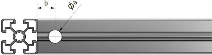
*In das Querprofil wird ein Durchgangsloch zur Aufnahme des Bolzens gebohrt.*
